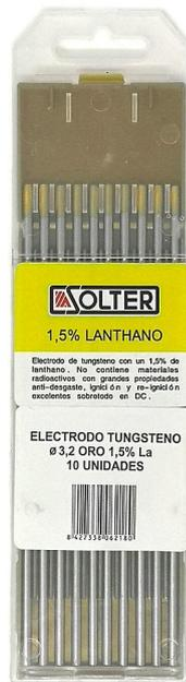
El Electrodo de Tungsteno Ø3,2 Oro 10udsde solter es ideal para aplicaciones de soldadura ideal para aplicaciones de **soldadura TIG en corriente continua (DC)**, ofreciendo estabilidad de arco y durabilidad. Este **electrodo de Ø3,2 mm**, compuesto de **tungsteno** con un **1,5% de lantano**, se presenta como una excelente alternativa al electrodo rojo sin componentes radiactivos, siendo una opción segura y de alto rendimiento para trabajos de precisión y calidad.
